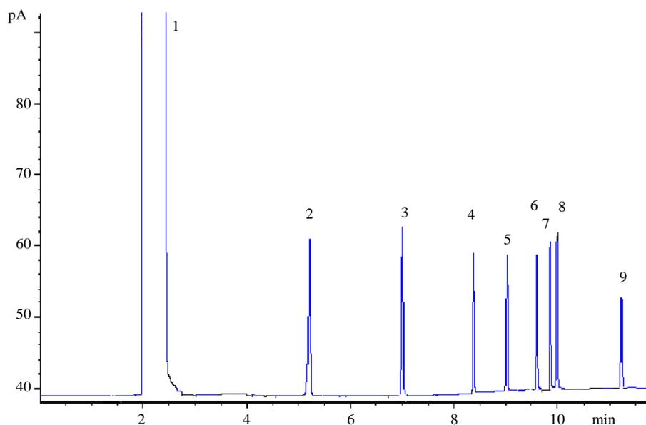
1—二氯甲烷；2—硝基苯；3—邻-硝基甲苯；4—间-硝基甲苯；5—对-硝基甲苯；6—2,6-二硝基甲苯；
