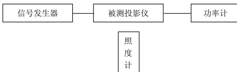
图 A.3: 工作模式下能耗测试框图
