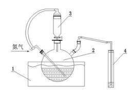
1-水浴; 2-500 ml反应瓶; 3-加酸分液漏斗; 4-100 ml吸收管。
