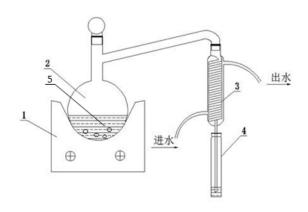
1—加热装置; 2—500 ml 蒸馏瓶; 3—冷凝管; 4—100 ml 吸收管; 5—防爆玻璃珠。
